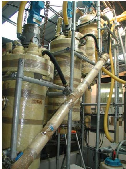
Stripping ammoniacal : à l'échelle laboratoire (à gauche), à l'échelle pilote (à droite)
